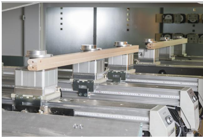
Fijación mecánica VCMC-K1 fijando marcos
